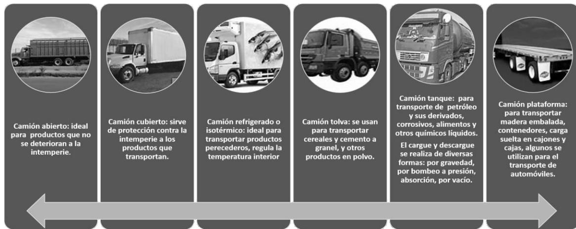
La imagen muestra los tipos de camiones según sus funciones específicas para cada tipo de producto a transportar, referencia tomada de (Sarache & Cardona, 2007, Pág. 70) Elaboración propia en power point.
