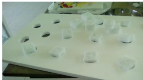
Figura 10. Colocación de hule espuma en los orificios de la placa de unicel
