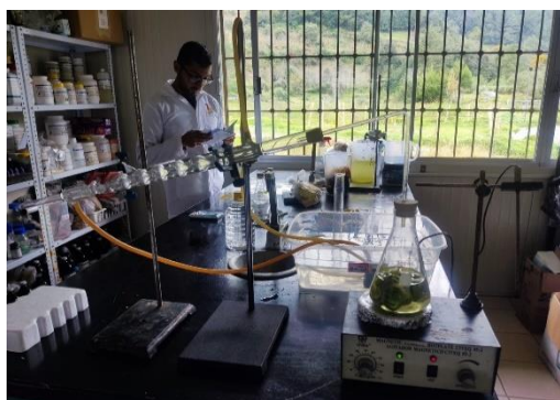
Figura A-21. Destilación a arrastre de vapor.
